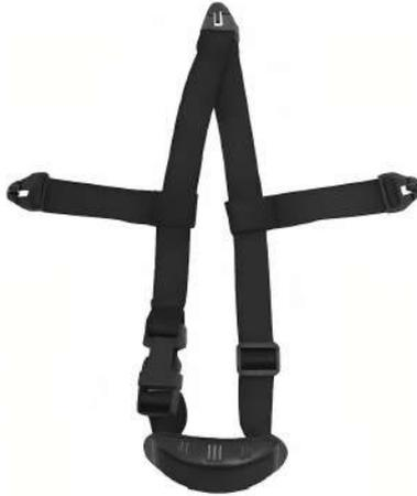
Barbuquejo en cinta elástica negra de 18 mm de ancho y elongación 70-80 con tres ganchos que se acoplan al casco. Por sus características de diseño es ideal para ser usado en la industria de la construcción, astilleros, explotación de petróleos y minas, construcción de túneles, en aserraderos, industria manufacturera, empresas de servicio público y en general donde existía posibilidad de caída del casco.
